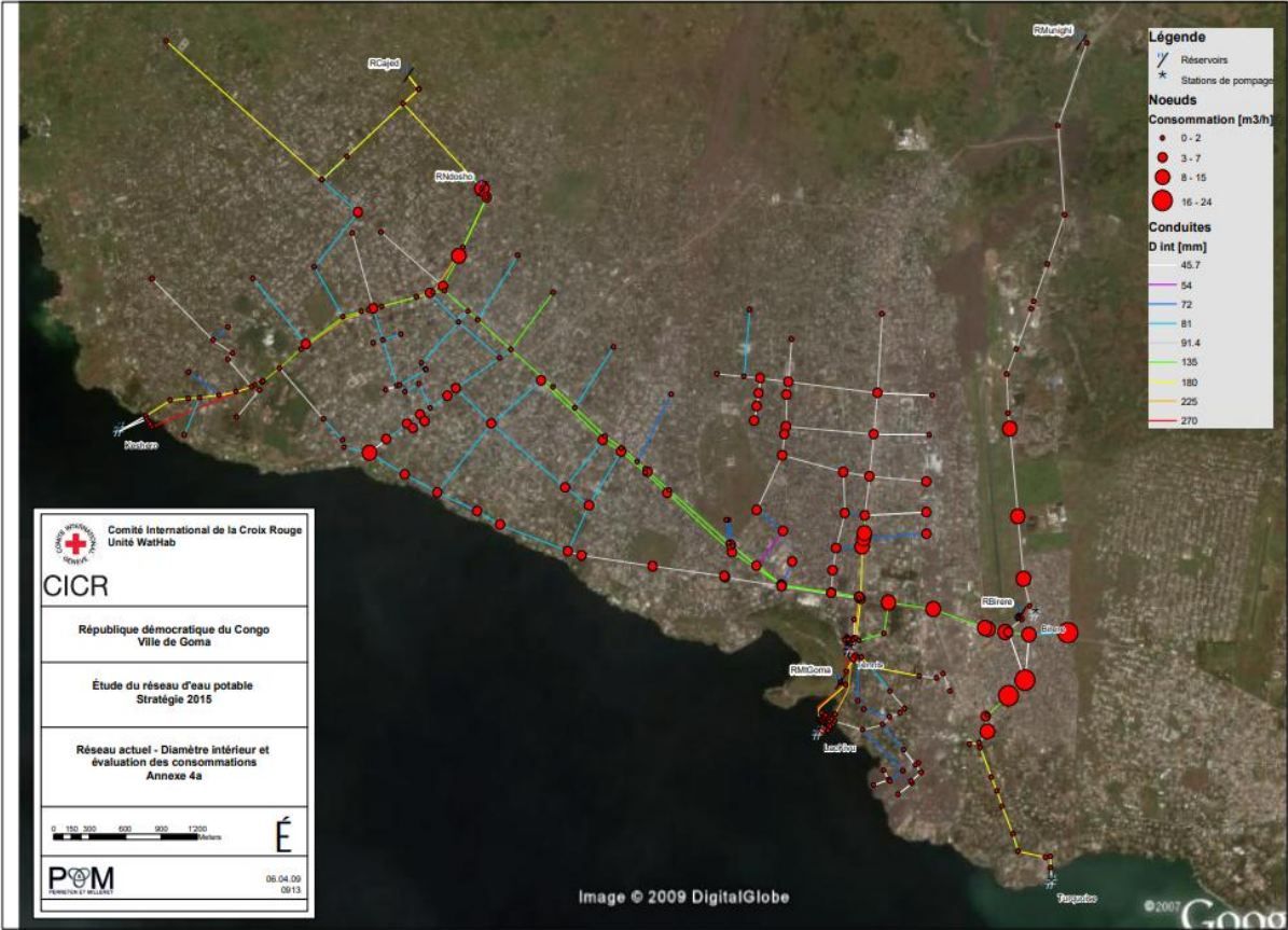
FIGURE 2 : SYSTEME D'AEP EXISTANT DE LA REGIDESO A GOMA-OUEST
